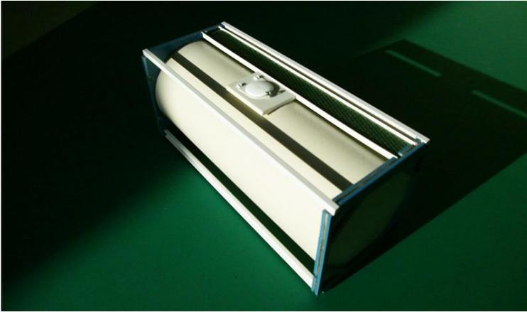
Auch werden die Winkel Profilen (3 x3 mm) auf die Ecke geklebt als Containerstütze.
